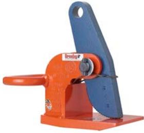
Die horizontale Hebeklemme IPH10 mit Federspannung ist mit einer Vorspannfunktion ausgestattet, was es dem Anwender ermöglicht, die Klemme sowohl an das horizontal zu hebende Material anzuschlagen als auch für die Bewegung von sich nicht biegender Material einzusetzen. Diese Klemmen müssen mindestens paarweise eingesetzt werden.
