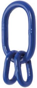
Die Güteklasse 10 Aufhängegarnituren TWN 1814 dienen zur Herstellung von 3- und 4-strängigen Kettengehängen. Die Herstellungs- und Prüfanforderungen basieren auf der DIN EN 1677 Teile 1 und 2, unter Berücksichtigung der Güteklasse 10 Tragfähigkeiten. Die Maße entsprechen der DIN 5688-3
