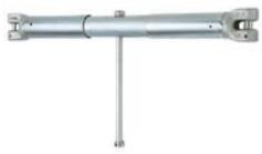
Die Güteklasse 10 Kettenspanner mit Knebel TWN 1454 werden als Spannelemente in Zurrketten eingesetzt. Die Kettenspanner können auch in Kettengehängen zur stufenlosen Stranglängen Anpassung beim Heben von Lasten eingesetzt werden. Diese Kettenspanner verfügen über einen extra großen Hub. Der Kettenspanner mit Knebel ermöglicht durch das Trapezgewinde eine hohe Vorspannkraft bei geringem
