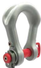
Geschweißter Schäkkel mit Sicherheitsbolzen und patentierter Crosby® Easy-Loc Schäkkelbolzensicherung. Gefertigt nach EN 13889 mit CE-Kennzeichnung. Alle Schäkkel mit RFID-Chip ausgestattet. Zugelassen für den Einsatz bei -40 °C bis 200 °C.
