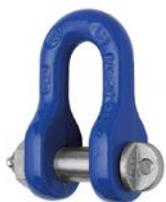
Die Güteklasse 10 Schäkel Form C mit Bolzen, Mutter und Splint TWN 1871 werden als Endbeschläge in Kettengängen eingesetzt. Der Gabelkopf dient dabei zur direkten Befestigung des Kettenstranges. Die Schäkel Form C können auch direkt an Laschen und Traversen montiert werden.
