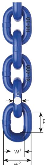
Die Güteklasse 10 Anschlagketten XL400 werden aus CrNiMo-Edelstahl hergestellt und dienen zur Herstellung von Kettengehängen und Zurrketten. Die max. Einsatztemperatur beträgt 380 °C. Die Prüfanforderungen dieser hochwertigen
