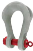
Geschweißter Schäkkel mit Sicherheitsbolzen, Mutter und Splint. Gefertigt nach EN 13889 mit CE-Kennzeichnung. Ab 30 t mit RFID-Chip ausgestattet. Zugelassen für den Einsatz bei -40 °C bis 200 °C.
