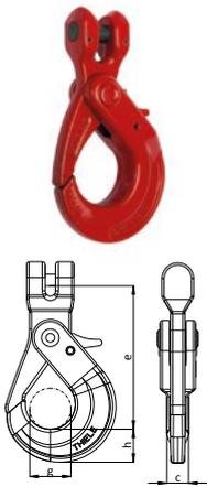
Die Güteklasse 8 selbstverriegelnden Haken mit Gabel TWN 0799 dienen zur Herstellung von Kettengehängen und finden häufig Anwendung in der Bauindustrie. Der Gabelkopf dient zur direkten Befestigung des Kettenstranges. Beim Belasten
