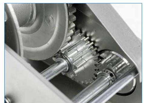
Die Zahnräder sind galvanisiert, sehr haltbar und korrosionsbeständig.
