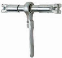
Die Güteklasse 10 Kettenspanner mit Ratsche TWN 1455 werden als Spannelemente in Zurrketten eingesetzt. Die Kettenspanner können auch in Kettengehängen zur stufenlosen Stranglängen Anpassung beim Heben von Lasten eingesetzt werden. Diese Kettenspanner verfügen über einen besonders großen Hub. Der Kettenspanner mit Ratsche ermöglicht durch das Trapezgewinde eine hohe Vorspannkraft bei geringem
